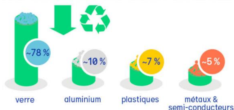
Figure 41 : Proportion et types de matériaux constituant un panneau
