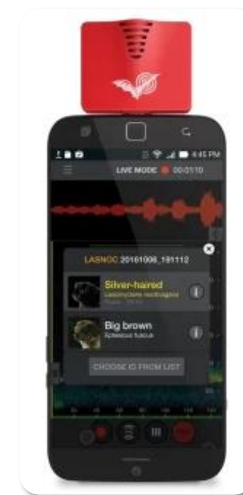
Figure 51 : EMT-PRO2 (Wildlife Acoustics) connecté à un smartphone
